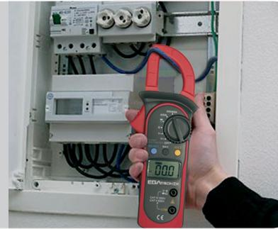
**2.** Capaz de tomar medidas de **voltaje AC/DC**, **corriente AC**, **resistencia**, **temperatura**, **diodos**, **continuidad**, etc. Así mismo, dispone de **indicadores acústicos y visuales**.
