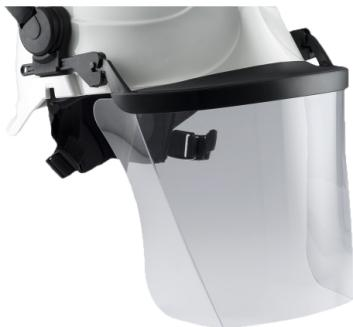
Visor externo removível, fabricado em policarbonato ótico transparente com 1,5 ou 2 mm de espessura, montado em suporte de ABS.
