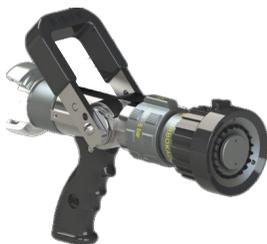
As peças de mão Turbokador são feitas de alumínio de alta qualidade, o que as torna extremamente leves. Maior resistência a danos mecânicos e químicos é obtida pela anodização de 50µ com Teflon. São equipados com proteção de cabeça contra impactos com borracha de poliuretano de alta qualidade. A alça ergonomicamente projetada permite um manuseio fácil e confortável da peça de mão. Todas as fivelas e parafusos são feitos de aço inoxidável.
